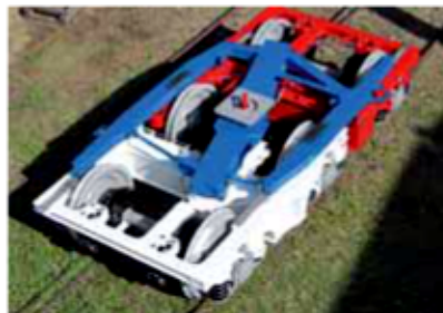
Zu den jüngsten Entwicklungen der TransTec Vetschau GmbH gehört ein dreiaxsiges Güterwagen-Drehgestell mit dreiteiligem Rahmen.
